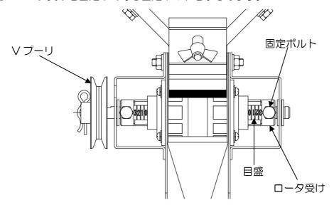
③ 目盛の面を正面に見てロータ受けを回転しないように固定します。 ※ゆるめたボルトをドタイバー等で押さえ付けてください。
