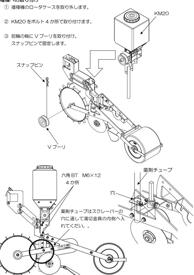
④ Vプーリに丸ベルトを取り付けます。 ベルトは8の字に取り付けます。薬剤ロータは進行方向とは逆方向に回ります。
