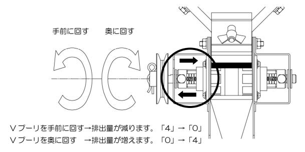
④ ご希望の目盛りに調節し、固定ボルトを締めてロータ受けを固定します。
